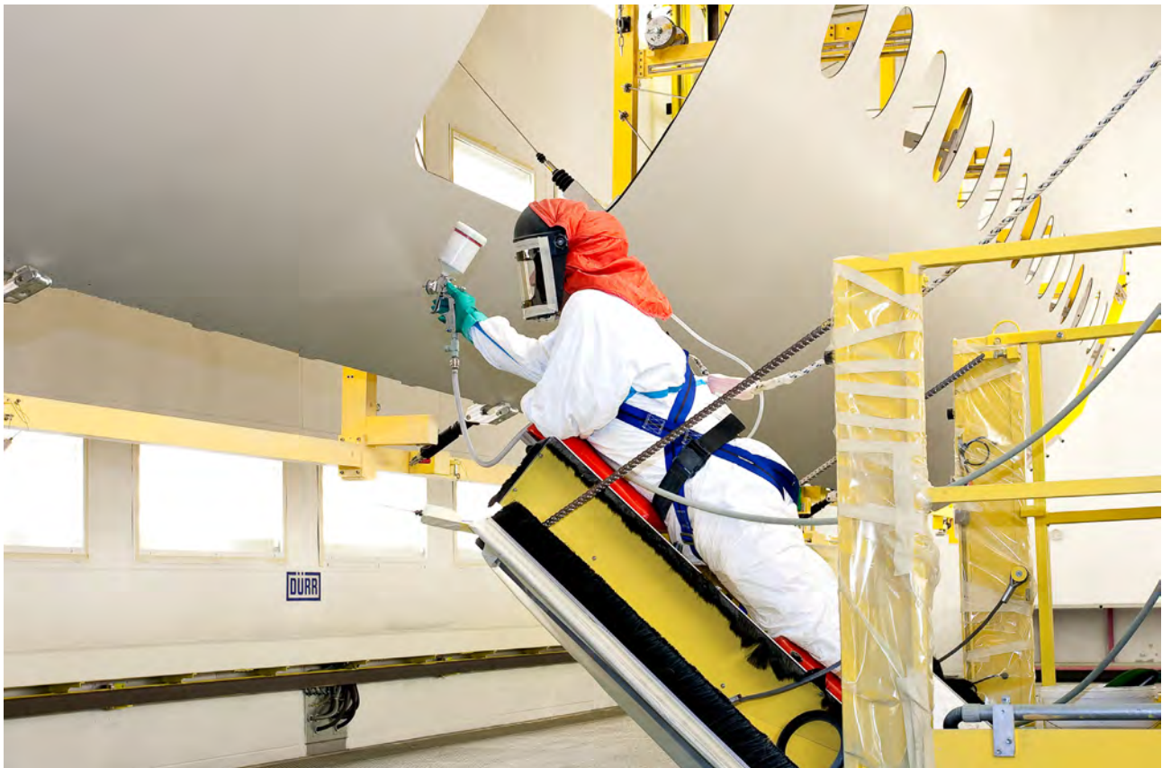
Lackieren von Großkomponenten aus Faserverbundkunststoff mit chromatfreien Grundierungen
