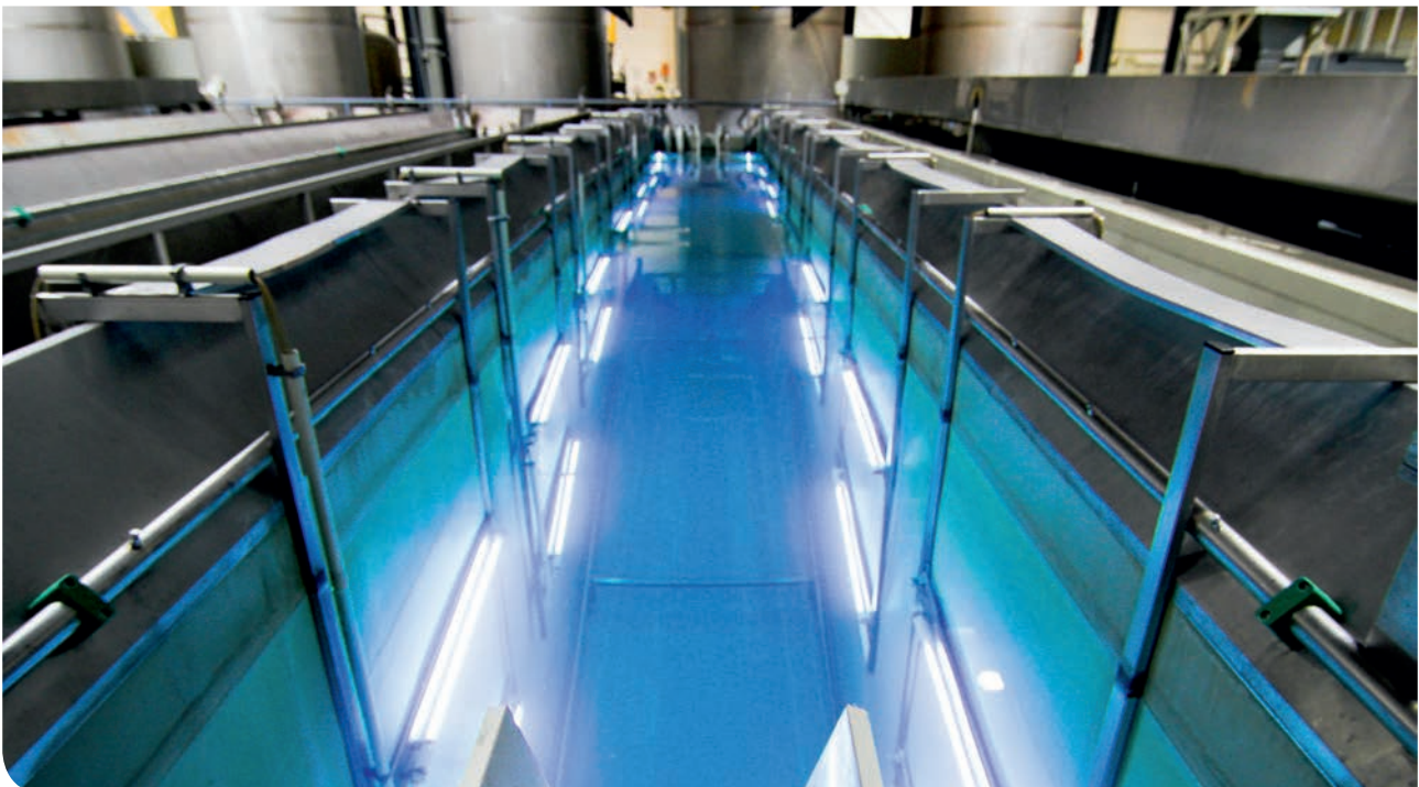
Galvanik- Spülbad der TSA-Anodisierreihe mit UV-Lampenausstattung
