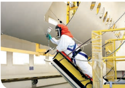
Lackieren von CFK mit chromatfreien wasserbasierten Grundierungen
