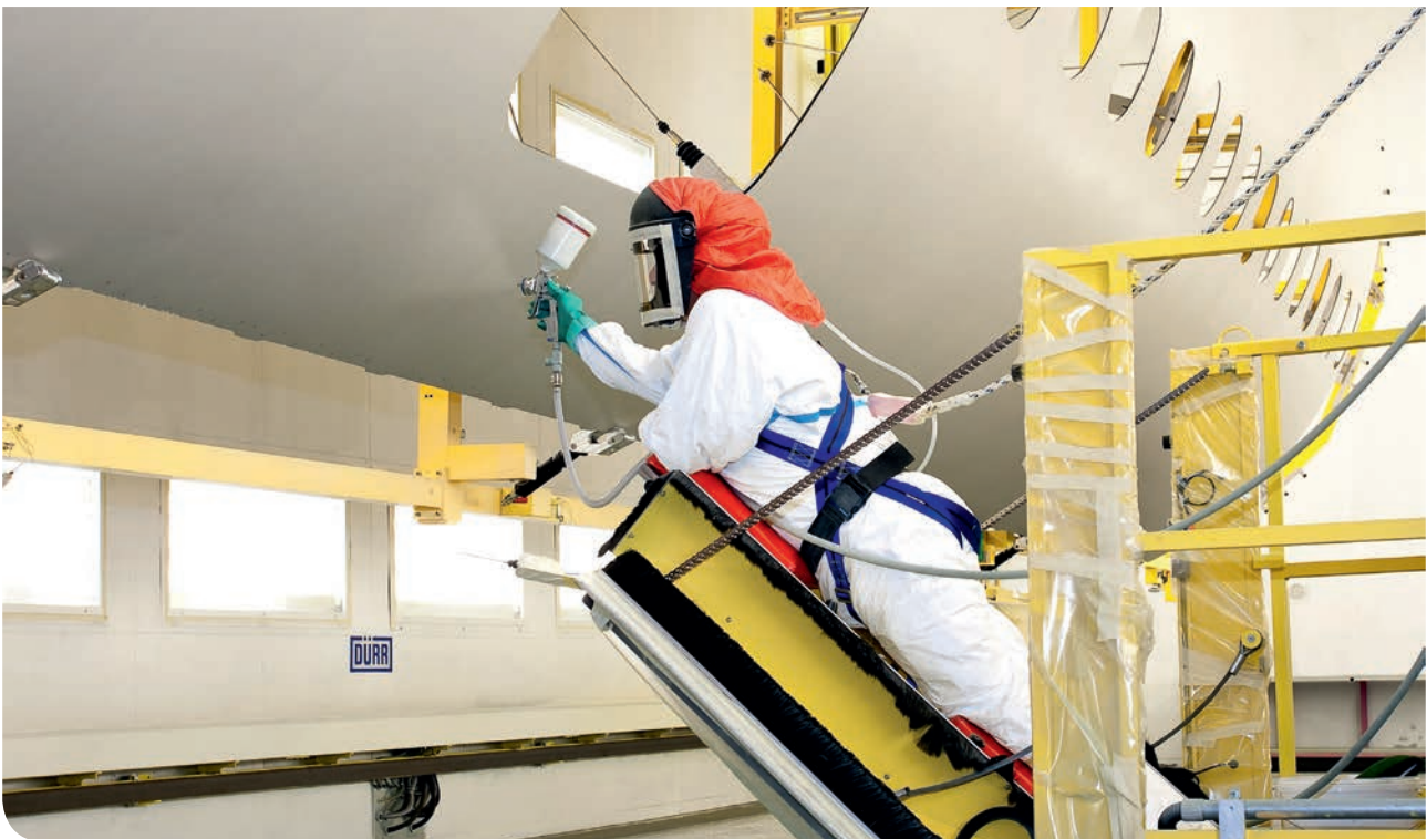
Lackieren von Großkomponenten aus Faserverbundkunststoff mit chromatfreien Grundierungen
