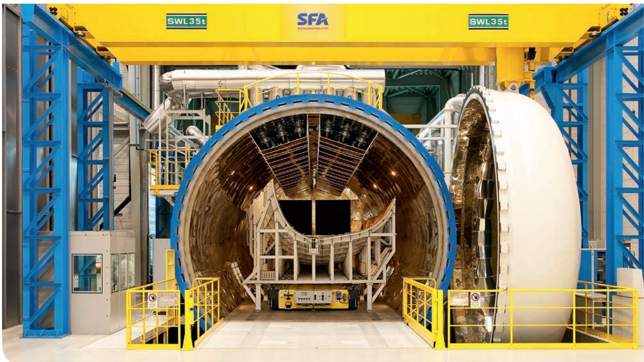
Aushärtetechnik für Faserverbundbauteilen in Großautoklaven bei Vakuum und Druck
